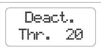
**Порог отключения:** когда *Brio Top* конфигурируется для работы в соединении с инвертером *Sirio* (режим работы задан на P+P и Всп. Кон. задан на “4”), можно регулировать данный параметр для определения порога отключения вторичного насоса. Вторичный насос, на который монтируется *Brio Top*, включается по требованию инвертера, который контролирует главный насос, когда давление будет ниже Pmin.
