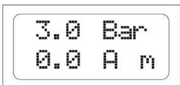
Когда устройство сконфигурировано для работы внутри станции со двойными насосами, включающимися поочередно, в нижней строке появляется указание “master” или “slave”, с включением букв “m” или “s”.
