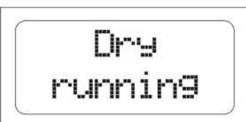
**Сухой ход:** это сообщение появляется, когда система останавливается из-за отсутствия воды на всасывании насоса. Если была включена функция автоматического сброса, *Brio Top* выполняет попытки автоматического запуска для проверки нового наличия воды. Для устранения состояния ошибки нужно нажать на центральную кнопку “reset” (сброс).
