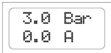
**Главный экран:** когда *Brio Top* работает нормально, на дисплее показано состояние устройства. В верхней строке указывается давление, измеренное в установке, а в нижней строке указывается ток, поглощенный двигателем. На этом экране можно держать нажатой кнопку “+” для того, чтобы насос работал форсировано, даже без наличия воды, чтобы исключить защиту от «сухого» хода и позволить залить водой сам насос.
