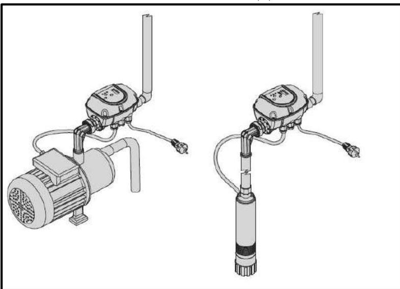
*Brio Top* может монтироваться на погружные насосы и на насосы, работающие на поверхности.
