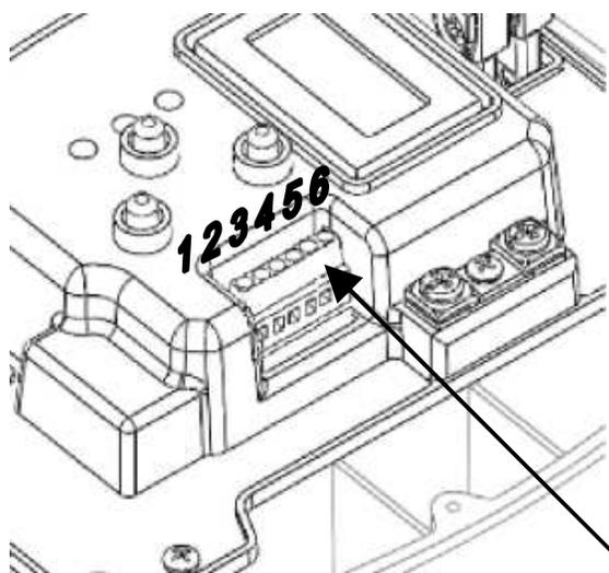
*Brio Top* оснащен соединителем, при помощи которого становятся доступны вспомогательные контакты для использования дополнительных функций, соединяя устройство с другими внешними аппаратами.
