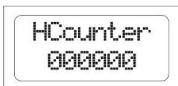
**Счетчик часов :** на этом экране можно посмотреть общее количество часов работы *Brio Top* (то есть время, в течение которого устройство было подключено к электропитанию). Нажав на кнопку “+” на этой странице можно показать число часов работы электронасоса.
