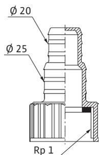
**TM 25: клапан обратного течения, патрубок для подключения шланга (Ø 20, Ø 25)**
